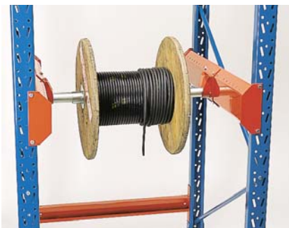
Kelan ripustus - itselukittuvalla akselilla. Kela säädettävissä sekä sivusuunnassa akselilla että syvyysuunnassa. Välikköpituus 950 ja 1350 mm.
